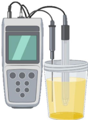
Fig. 07. Utilizarea unui pH-metru pentru determinarea unei valori exacte pentru proba de urină.
